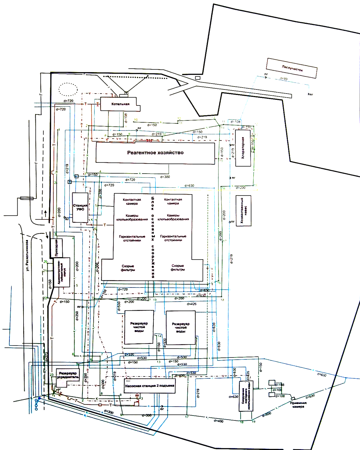
Рисунок 6 – Технологическая схема очистных сооружений водопровода
