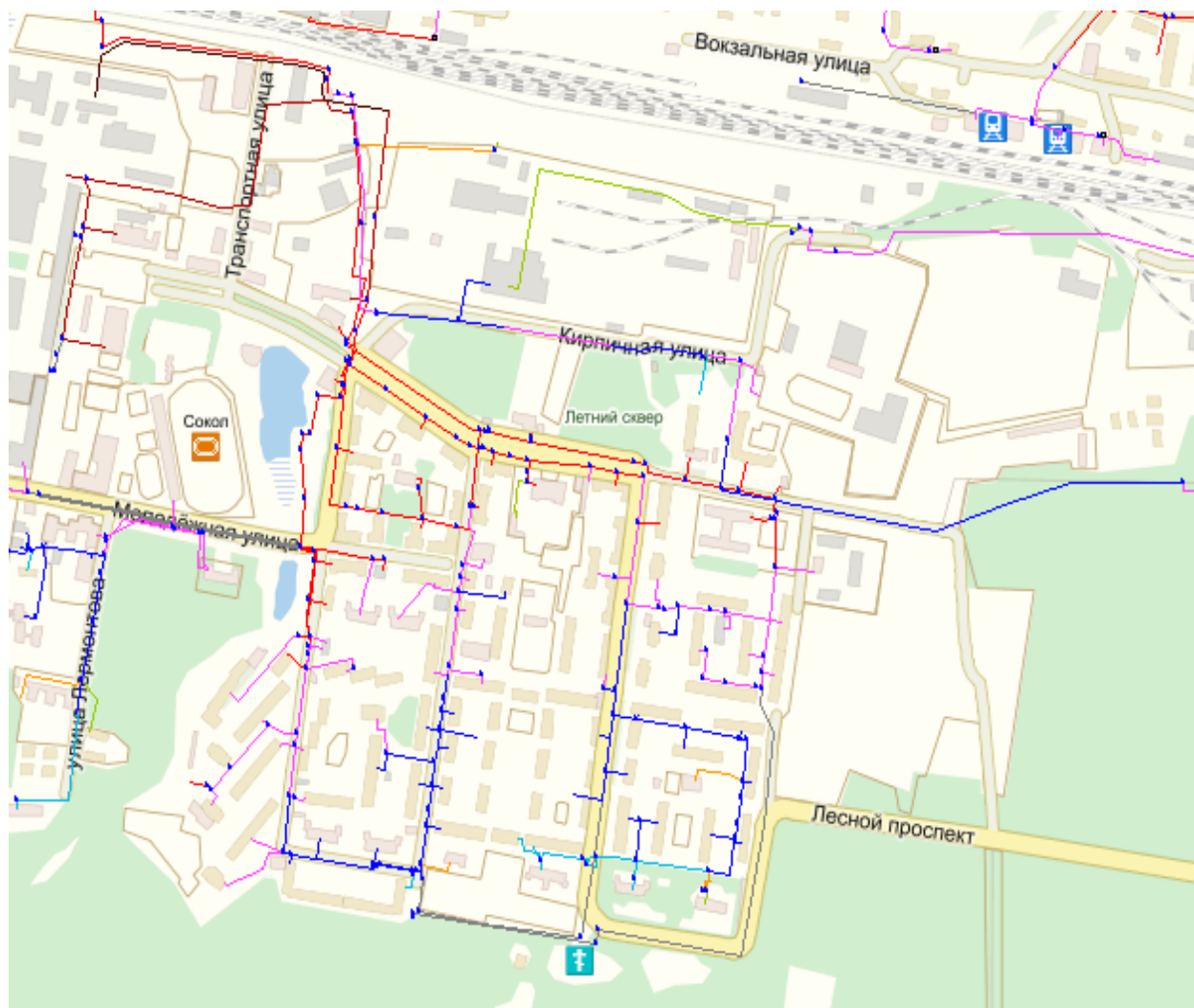
Рисунок 64 – Распределение давления в магистральных и квартальных участках водопроводной сети зоны водоснабжения ВНС-Южный г. Сарапула
