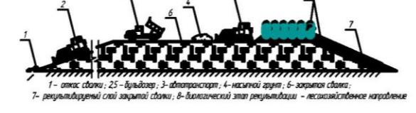
Технологическая схема рекультикации свалки без переработки свалочного грунта
